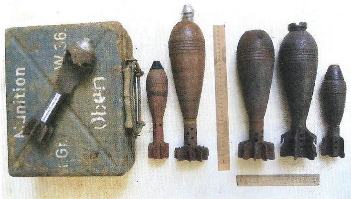
Слева на право: Германия: ящик герметичный для мин 5,0см; мина 5,0см; мина 8,1см (81,4 мм). СССР: мина 82 мм десятиперая; мина 82 мм шестиперая с транспортной пробкой; мина 50 мм.
