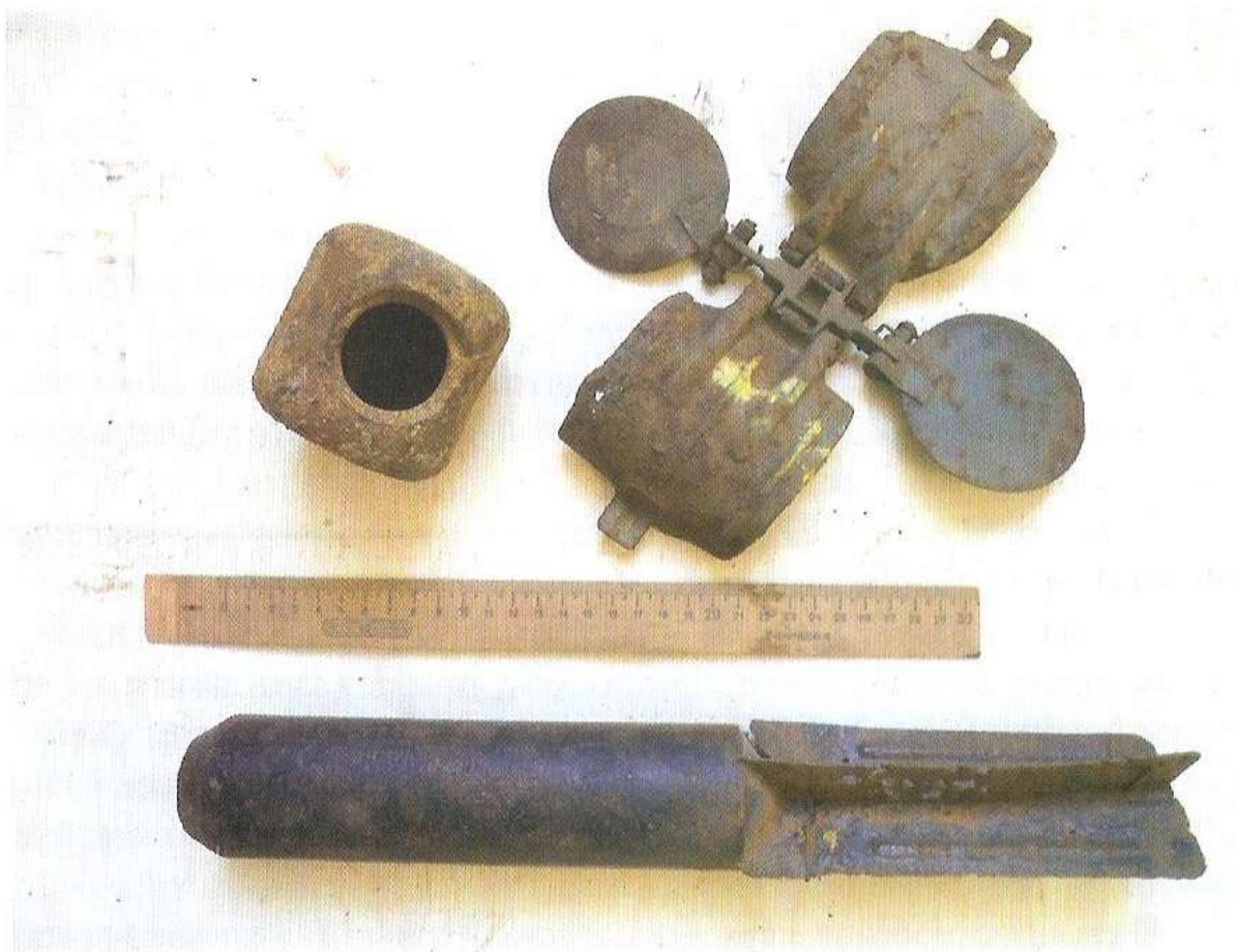
Вверху: корпус и кожух-ветрянка осколочной бомбы SD-2 (Германия). Внизу: авиабомба осколочная АО-2,5 (СССР).
